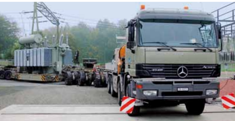
EKZ Transportzug: Transport eines 40-MVA-Trafos.
