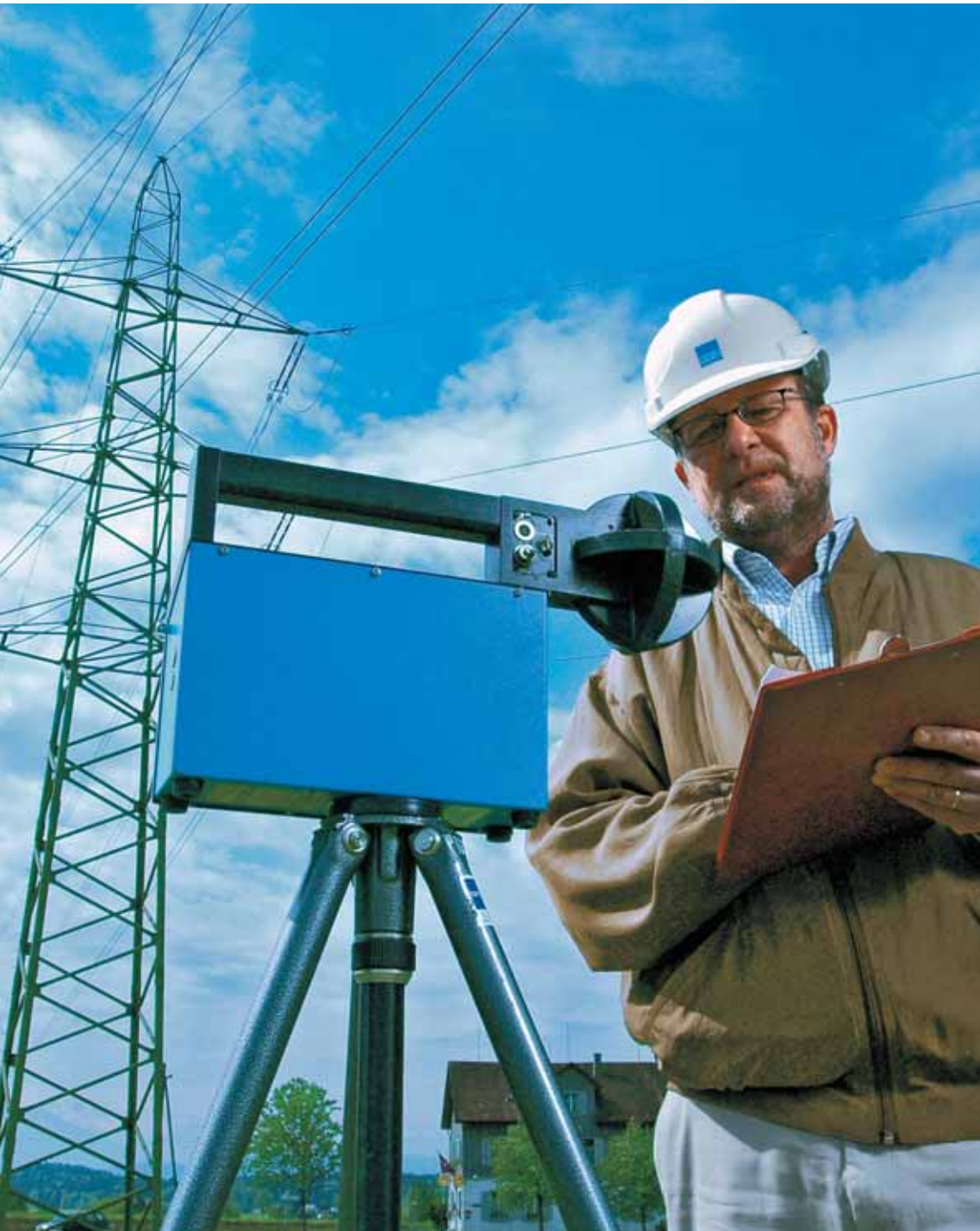
EKZ Fachmann Robert Furrer misst die elektromagnetische Strahlung.
