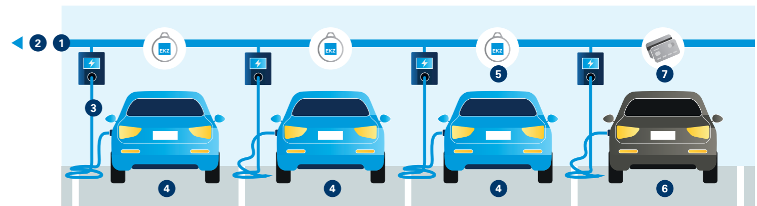
Abb. 1: Das Lademanagement regelt die Ladevorgänge der einzelnen Ladestationen.
